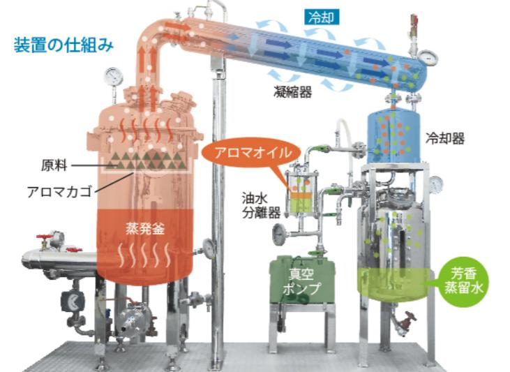
ボイラーから供給する蒸気によって、原料に含まれる精油が揮発して水蒸気になって立ち上ります。その気体を冷却することで、凝縮された気体が液体へ変わります。液体に精油と蒸留水が含まれており、油水分離器にて、精油と蒸留水に分かれます。
